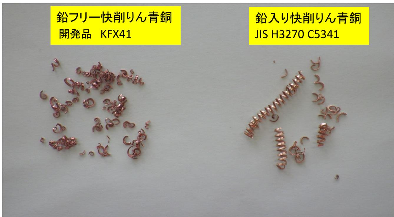
※旋盤による面削屑(φ17材、回転数450rpm、送りピッチ0.75mm、切り込み深さ0.5mm)
