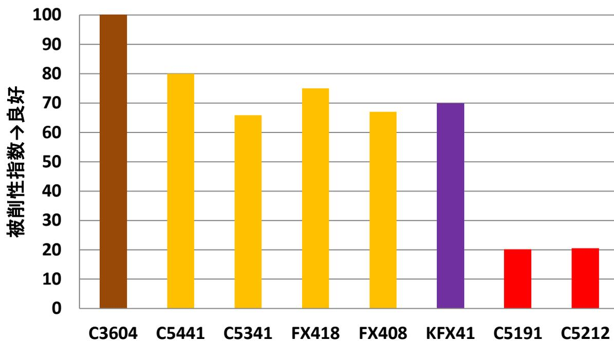
※ドリル抵抗、面削、切屑形状より総合的に評価しています
